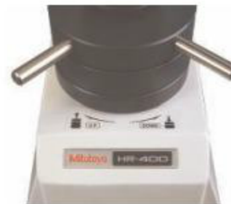
Freno automatico sulla manopola di sollevamento tavola
